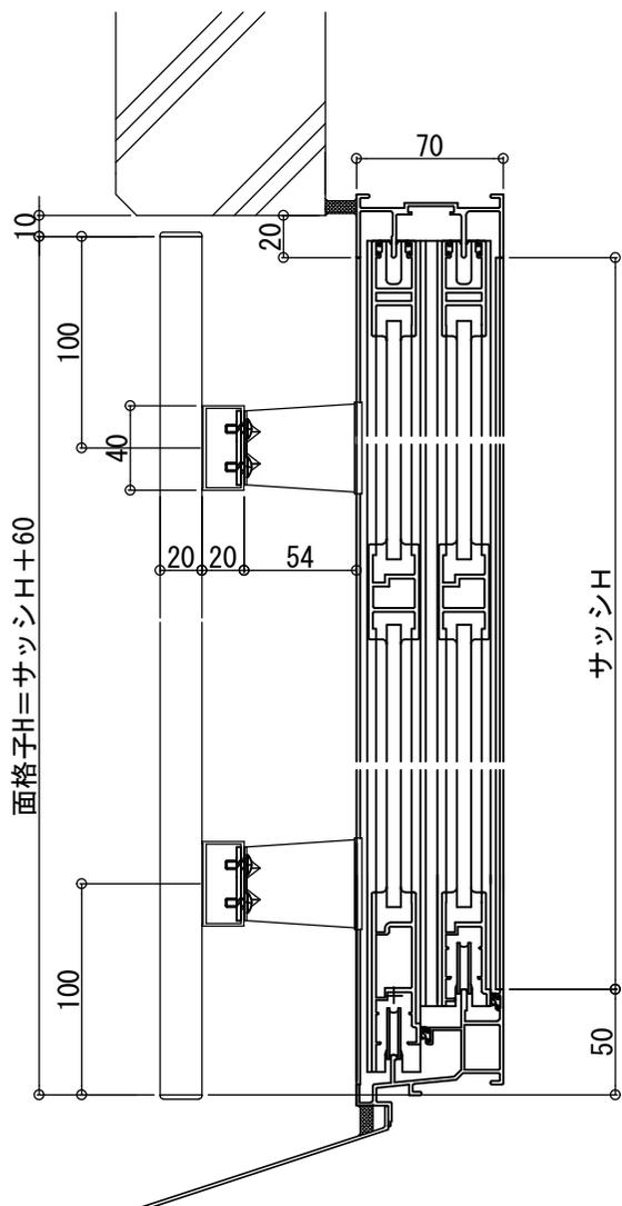
※：指示がなければ面格子H $\geq$ 1421の時、W材が1本追加されます。
