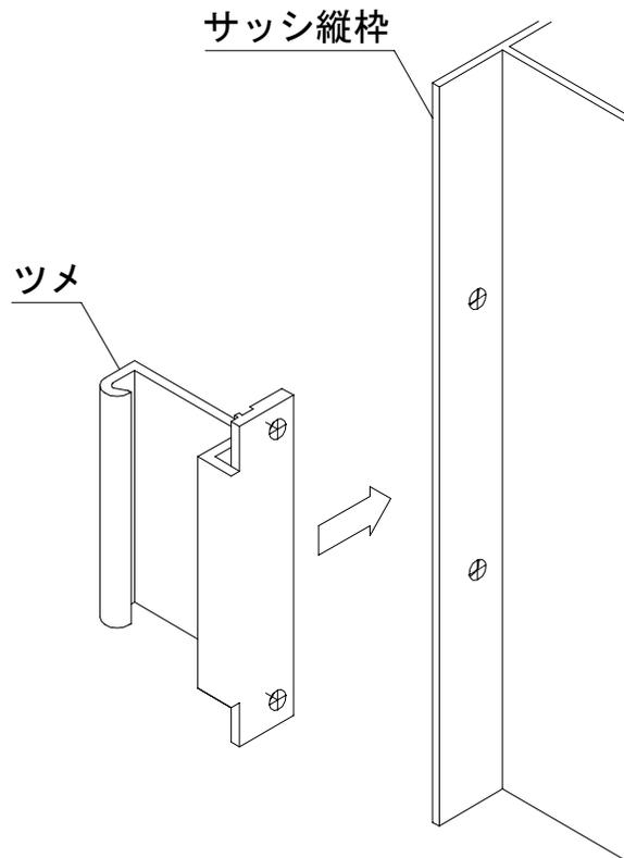
メーカーの自走防止ストッパー（戸先側）の穴位置に合うように、“ツメ”をサッシ縦枠に差込みます。
