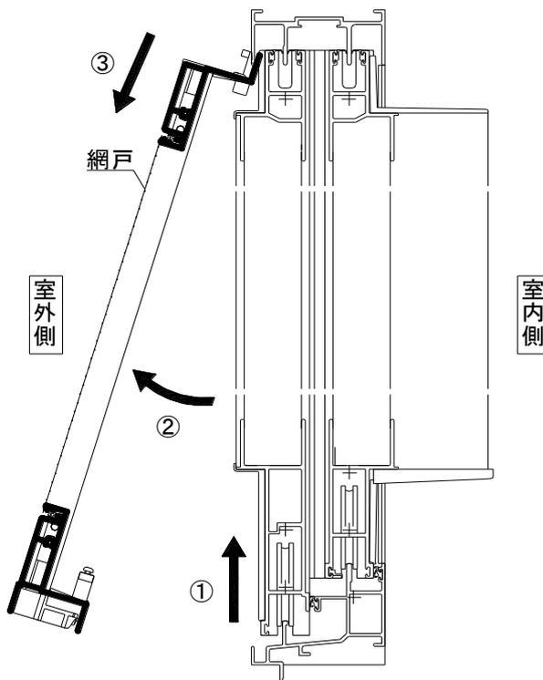
※手順に従って網戸の取り外しを行わなかった場合、網戸又は網戸の部品が破損する原因となります。
